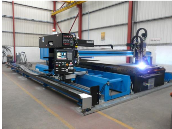
Corte Oxicorte y plasma CNC
