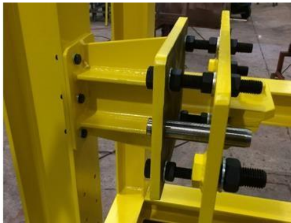
Joints boulonnés Pré-assemblage
