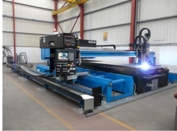
Découpage Oxycoupeur et plasma CNC
