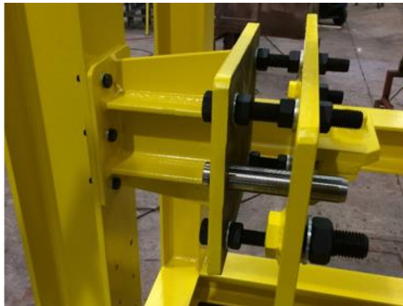
Uniones atornilladas Pre-montaje
